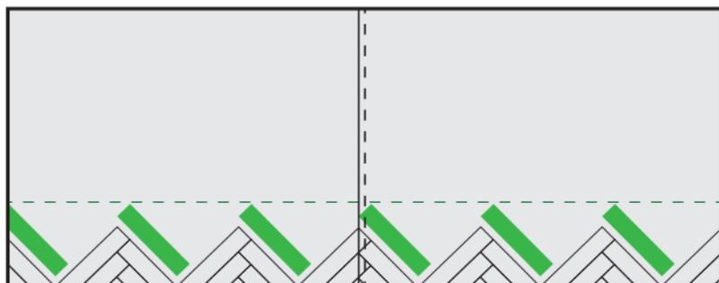
Nå kan B-elementene installeres fortløpende, elementet til høyre tilpasses veggen.
