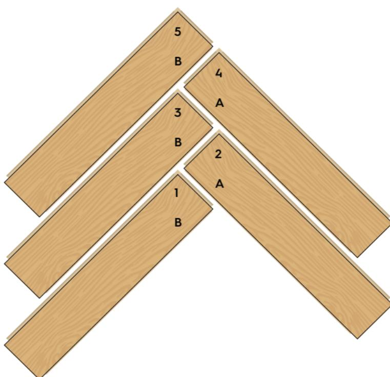
Setzen Sie die Dielen exakt und in der angegebenen Reihenfolge zusammen. Überprüfen Sie die Verbindung zwischen den Dielen nach jeder installierten Dielen. Von einer Dielen zur nächsten dürfen keine Überstände zu spüren sein!
