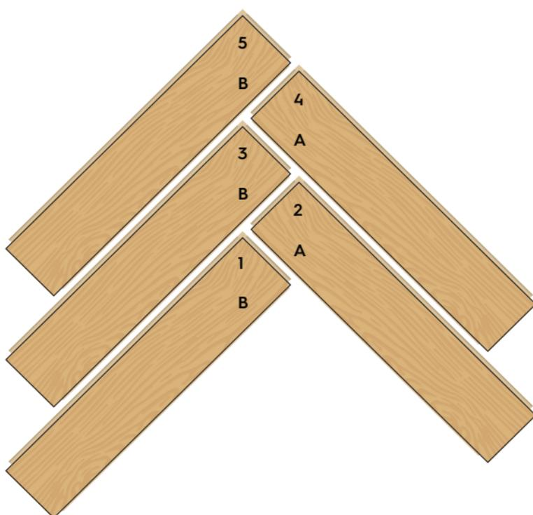
Monter elementene nøyaktig og i rekkefølgen som er angitt av tallene på tegning. Kontroller skjøtene mellom elementene etter hvert som elementene blir montert. Vær nøyaktig!
