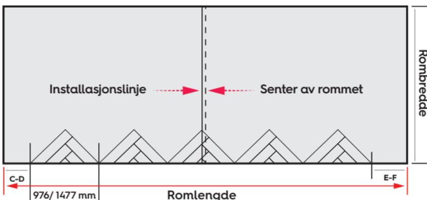
Skjær elementene i avstandene C-D og E-F fra de to (eller en) resterende trekantene. Og plasser dem som vist på tegningen:
